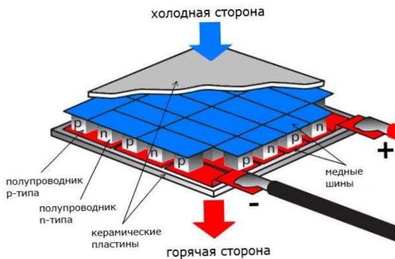
Рисунок 2 – Принцип работы модуля Пельтье
