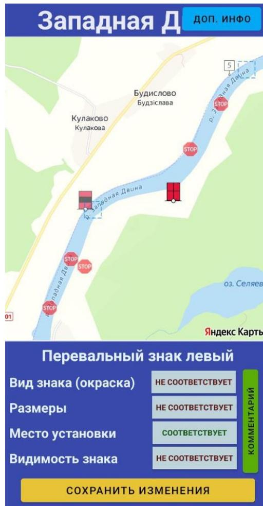
Рисунок 1 – Экран мобильного приложения при проведении осмотра
