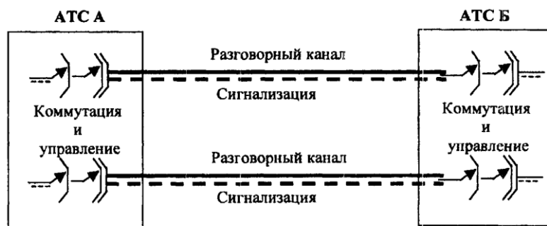
Рисунок 2.3 – Сигнализация по телефонному каналу
