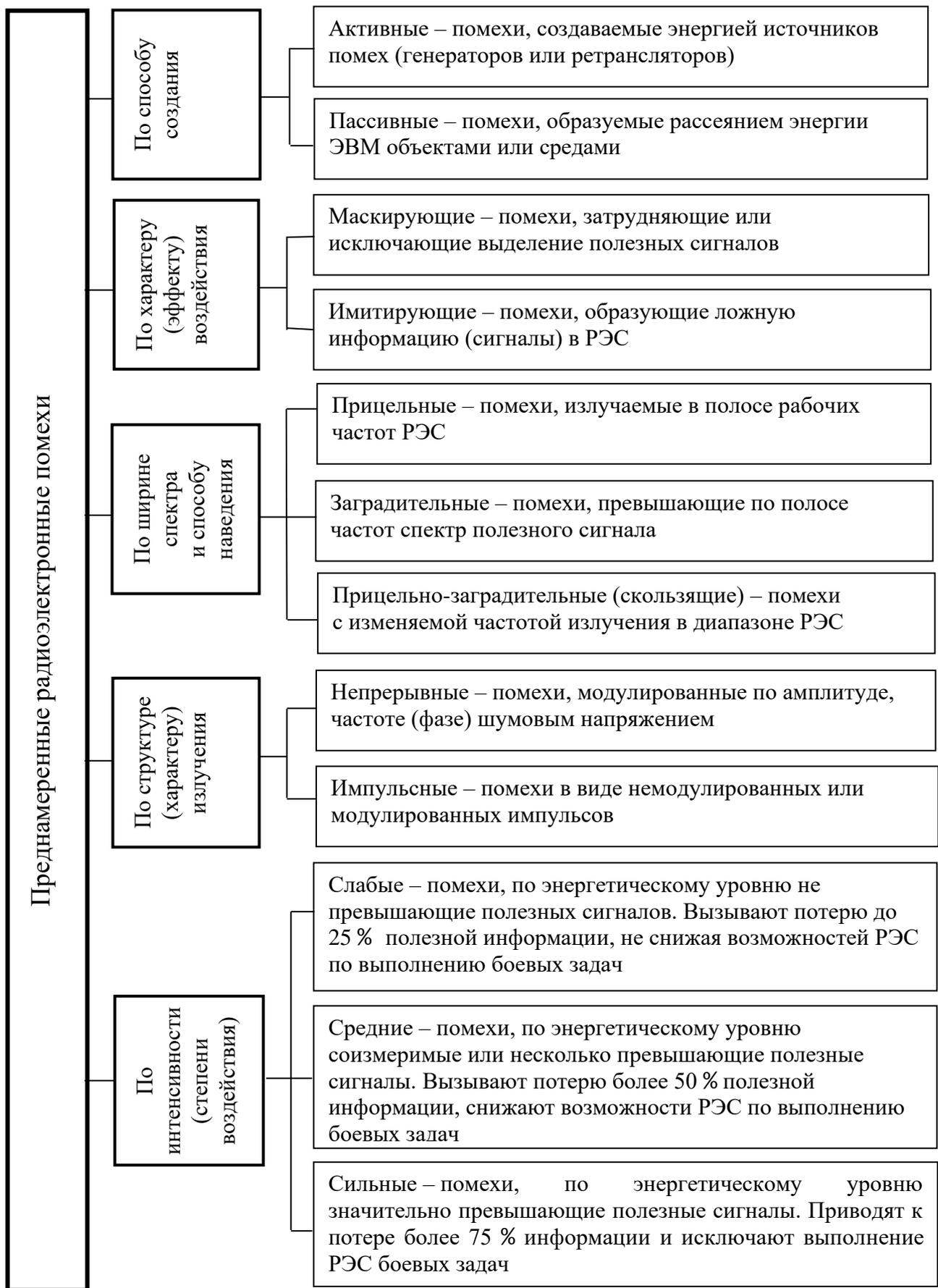
Рисунок 7.1 – Классификация преднамеренных радиоэлектронных помех
