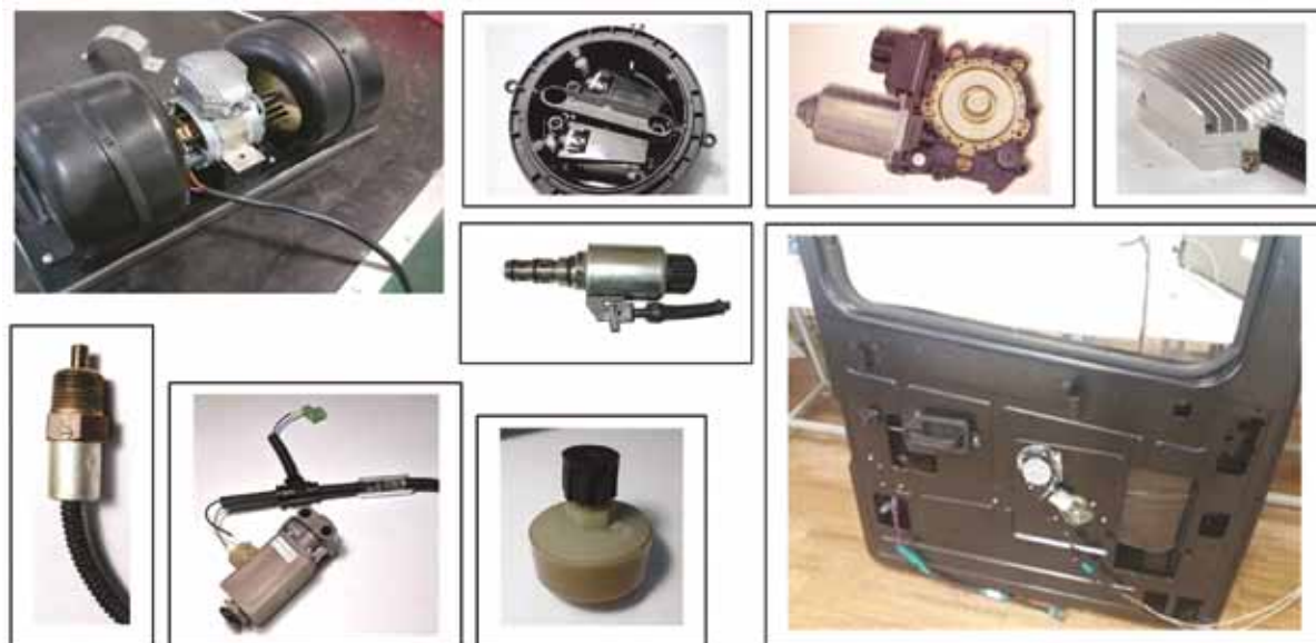
Рис. 7. Опытные образцы интеллектуальных устройств для существующей распределенной бортовой системы автомобиля МАЗ, разработанных с использованием микромодулей и серийно выпускаемых в Республике Беларусь датчиков и механизмов
