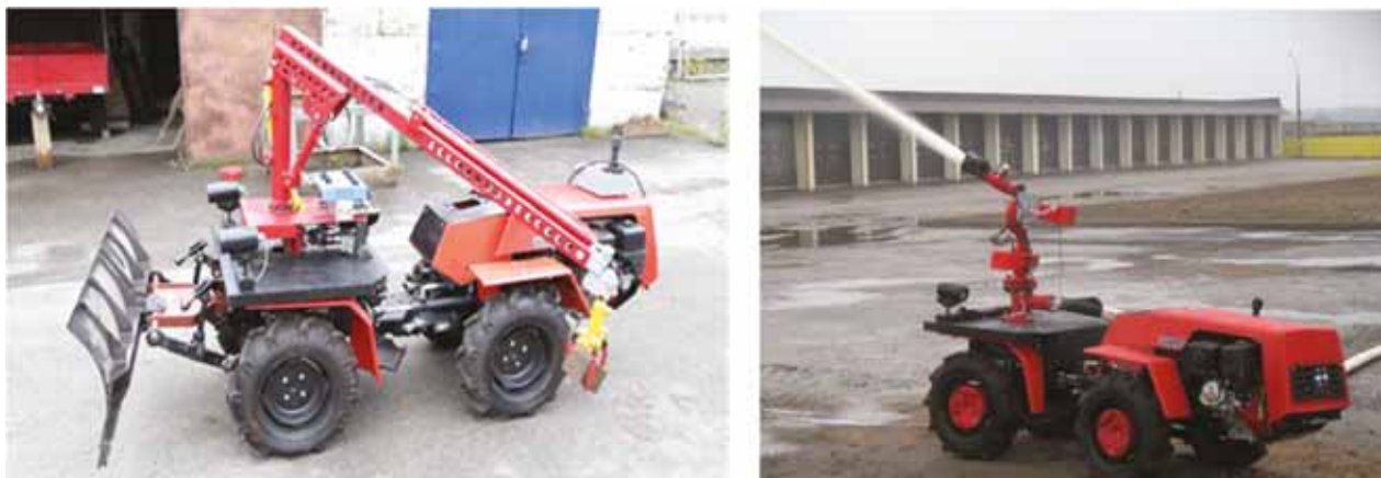
Рис. 4. Опытные образцы мобильных робототехнических комплексов на базе мини-трактора «Беларус» с распределенной системой управления бортовой мехатроникой
