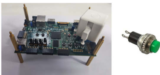
Рис. 2 – Рассмотренные в эксперименте коммутаторы и устройство Fingerbot
