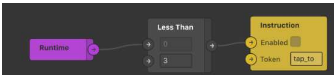
Рисунок 103 – Пример визуального программирования для AR-эффекта: установка времени работы эффекта 72
