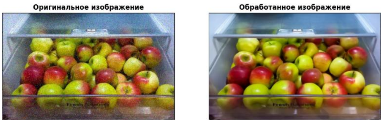
Рисунок 4. Результат обработки входного изображения медианным фильтром
