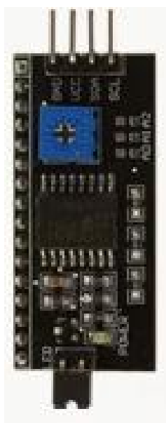
Рисунок 2. Модуль интерфейса I2C
