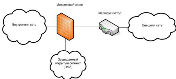
Рисунок 3 – Схема с раздельной защитой закрытой и открытой подсетей на основе одного фаервола с тремя сетевыми интерфейсами
