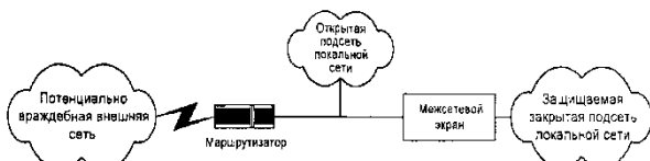
Рисунок 2 – Схема с защищаемой закрытой и не защищаемой открытой подсетями
