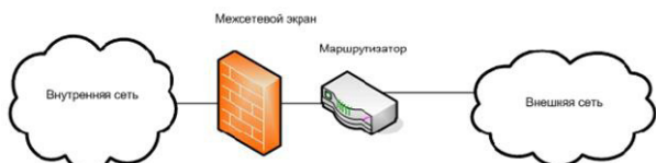
Рисунок 1 – Схема единой защиты локальной сети
