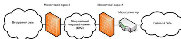
Рисунок 4 – Схема с раздельной защитой закрытой и открытой подсетей на основе двух фаерволов с двумя сетевыми интерфейсами
