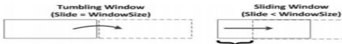
Рисунок 1. Семантика «переворачивающегося» и «скользящего» окна
