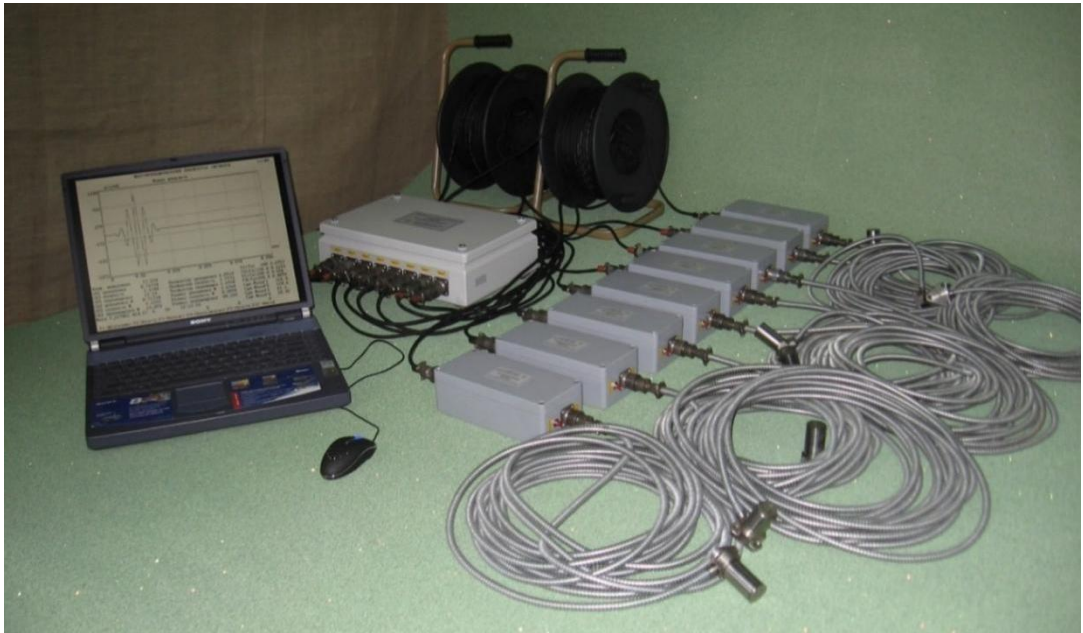
Рисунок 7. ИВК «Тембр» для непрерывной регистрации вибрационных сигналов
