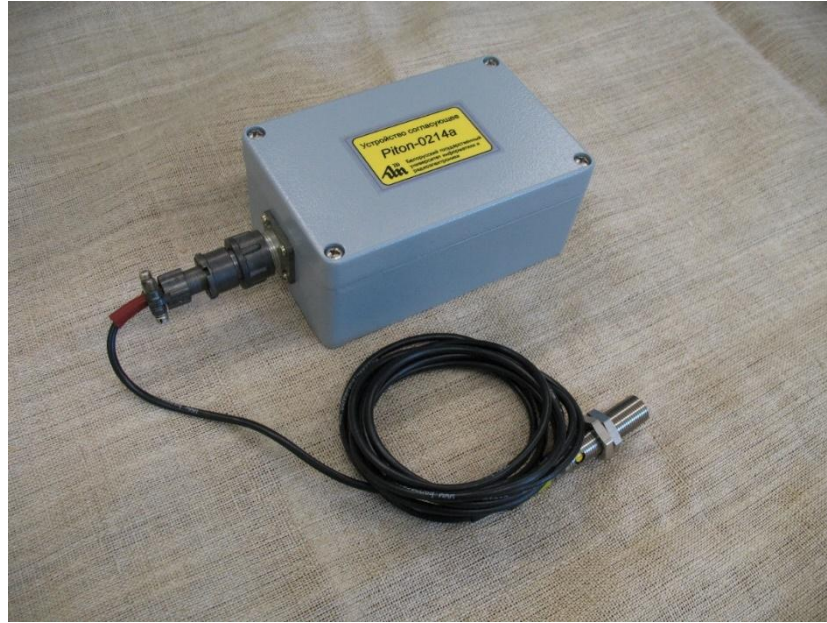
Рисунок 2. Датчик фазовой метки и согласующий усилитель
