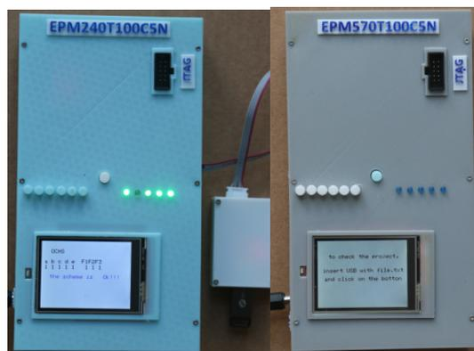
Рисунок 4 – Пример макета на ПЛИС EPM240T100C5 и EPM570T100C5
