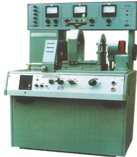
Рис. 2.7. Контрольно-испытательный стенд для контроля и регулировки снятого с автомобиля электрооборудования
