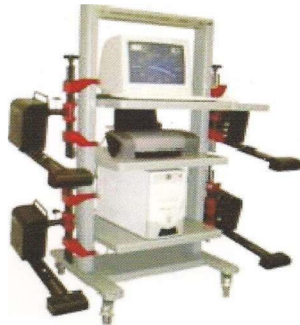
Рис. 7.20. Компьютерный стенд с инфракрасной связью для развала-схождения на четыре колеса автомобиля
