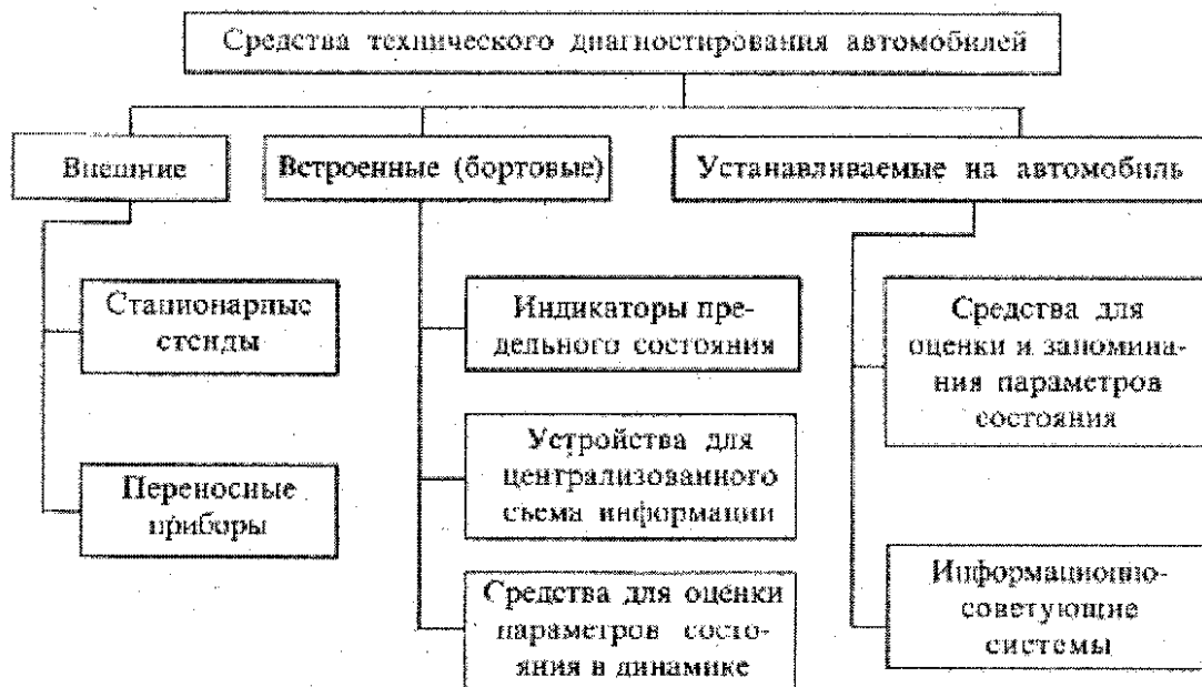
Рис. 4.1. Классификация средств технического диагностирования автомобилей
