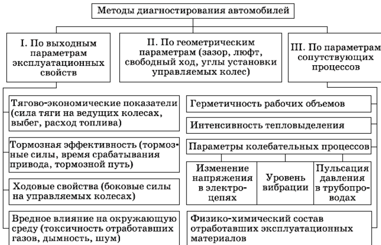
Рис. 3.1. Классификация методов диагностирования автомобилей
