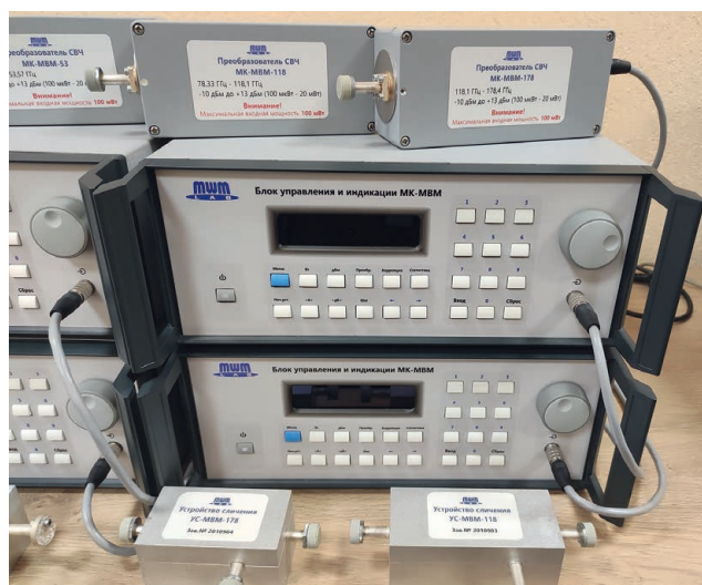
Рис. 10. Калориметрический измеритель мощности типа МК-МВМ Fig. 10. Calorimetric power meter type МК-MBM
