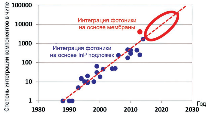
Рис. 2. Закон Мура в кремниевой фотонике Fig. 2. Moore's law in silicon photonics
