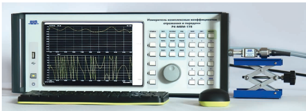
Рис. 3. Векторный анализатор цепей типа P4-MBM Fig. 3. Vector network analyzer type P4-MBM
