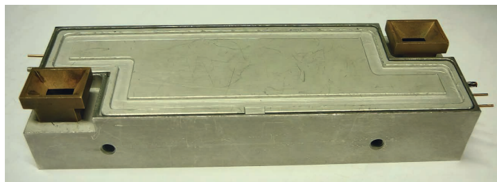
Рис. 6. Высотомер, работающий в диапазоне частот от 31,80 до 33,40 ГГц Fig. 6. Altimeter operating in the frequency range from 31.80 to 33.40 GHz
