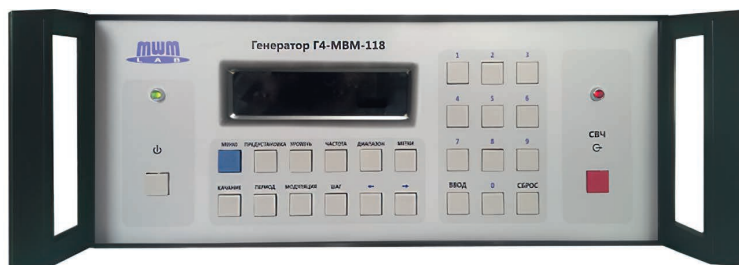
Рис. 4. Генератор СВЧ типа Г4-МВМ Fig. 4. Microwave generator type Г4-МВМ
