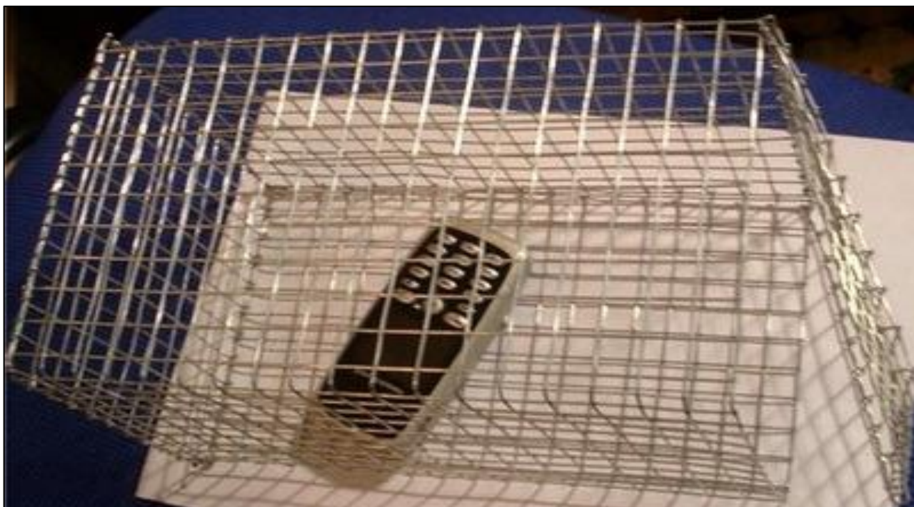
Рисунок 1 – Пример использования сетки Фарадея
