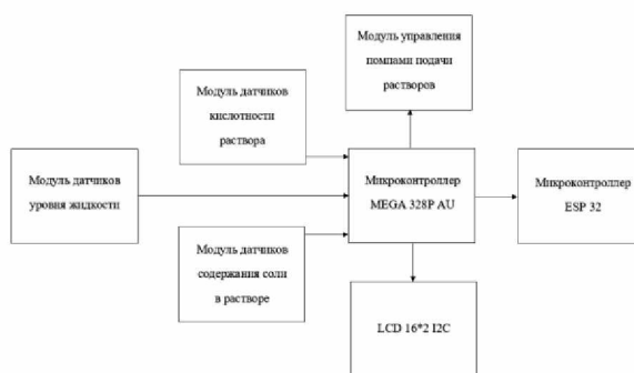
Рис. 1. Структурная схема регулятора состава питательных растворов
