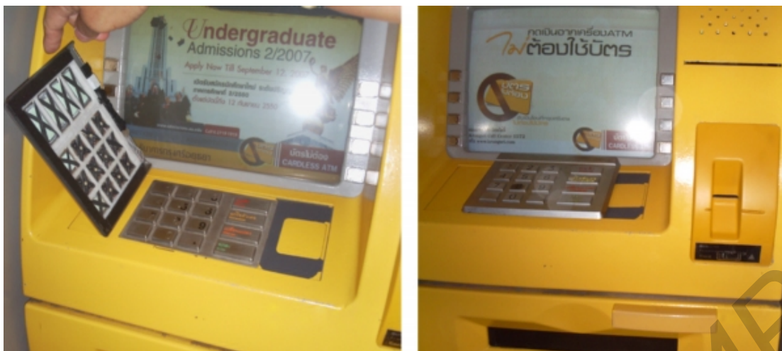
Рис. 4.2. Внешний вид накладного PIN-PAD
