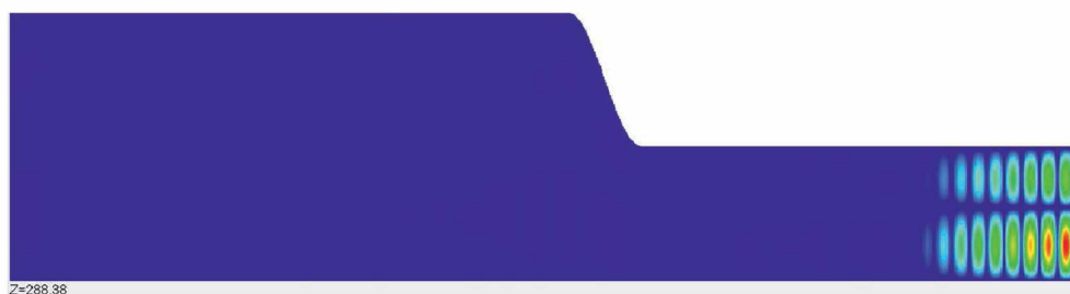
Рис. 5. Распределение модуля напряженности электромагнитного поля в продольном сечении волновода Fig. 5. Distribution of the electromagnetic field intensity modulus in the longitudinal section of the waveguide
