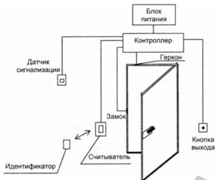
Рис. 5.3. Схема автономной СКУД
