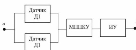
Рисунок 2 – Структурная схема надёжности исследуемой ЭСБ
