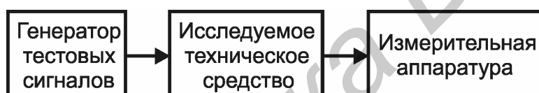
Рис. 9.4. Структурная схема проверки технических средств на отсутствие самовозбуждения
