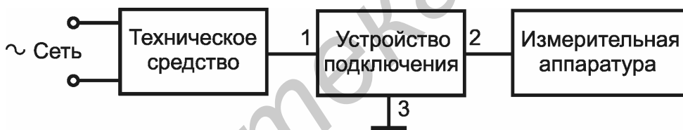
Рис. 9.7. Структурная схема измерения опасных напряжений в цепи заземления в диапазоне частот от 1 МГц до 1 ГГц
