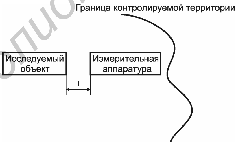
Рис. 9.3. Измерение уровня ПЭМИ в непосредственной близости от объекта
