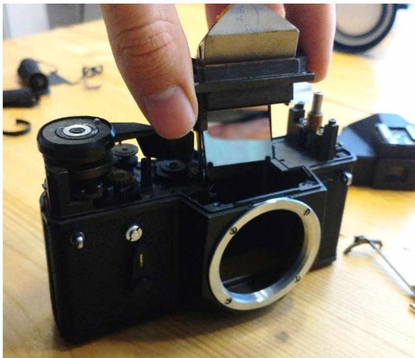
Рисунок 6 – Извлечение пентапризмы и зеркала из «Зенит ЕТ»
