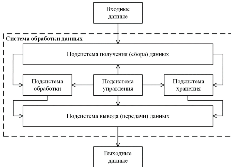
Рис. 2. Обобщенная структура системы обработки данных
