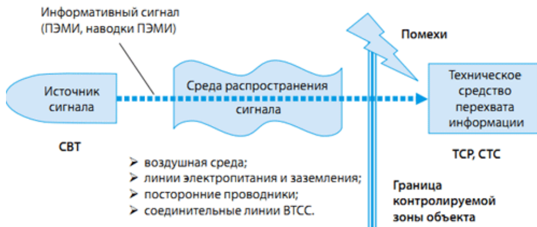
Рисунок 2 – Схема технического канала утечки информации, обрабатываемого средствами вычислительной техники
