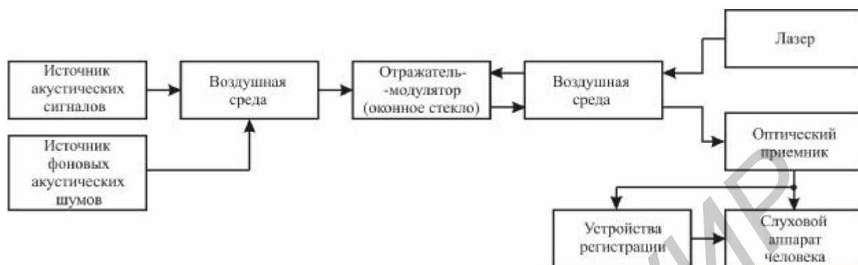
Рис. 5. Структурная схема акустооптического канала
