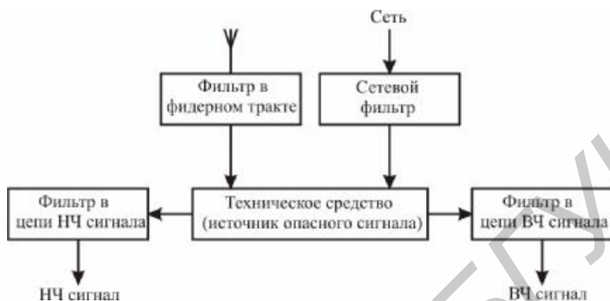
Рис. 16. Обобщенная схема фильтрации
