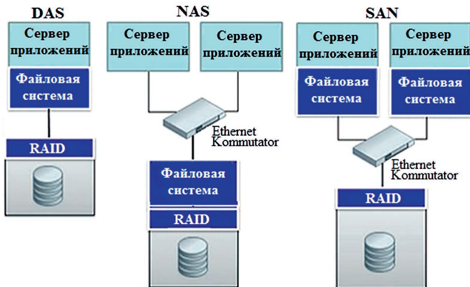
Рис. 1. Общая структурная схема технологий DAS, SAN и NAS Fig. 1. General structural diagram of DAS, SAN and NAS technologies
