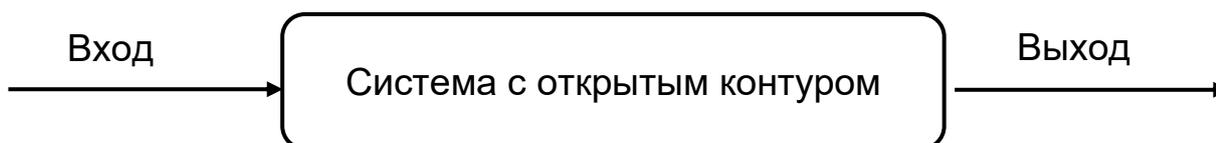
Рисунок 1.2 – Система управления без обратной связи
