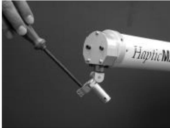
Рисунок 1.7 – Концевой эффектор, на котором закреплена отвертка
