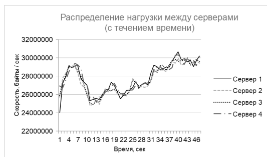
Рис. 4 – Распределение нагрузки между серверами
