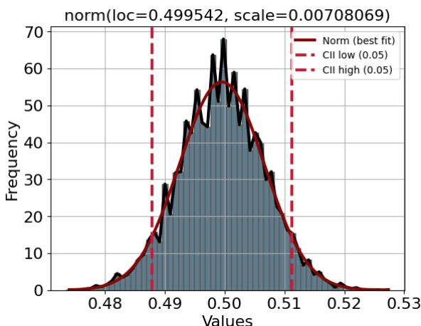
Рис. 2 – Распределение единообразия для 10000 прогонов модели со случайными задержками
