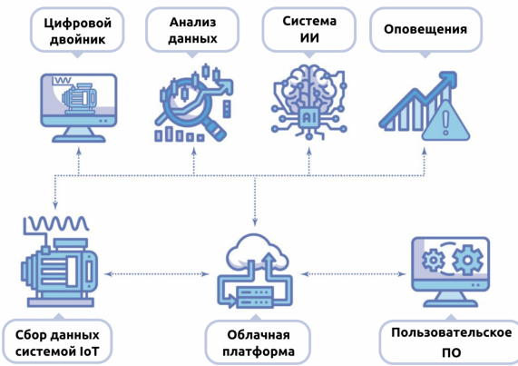
Рис. 2 – Архитектура системы ПдО на с использованием ИИ
