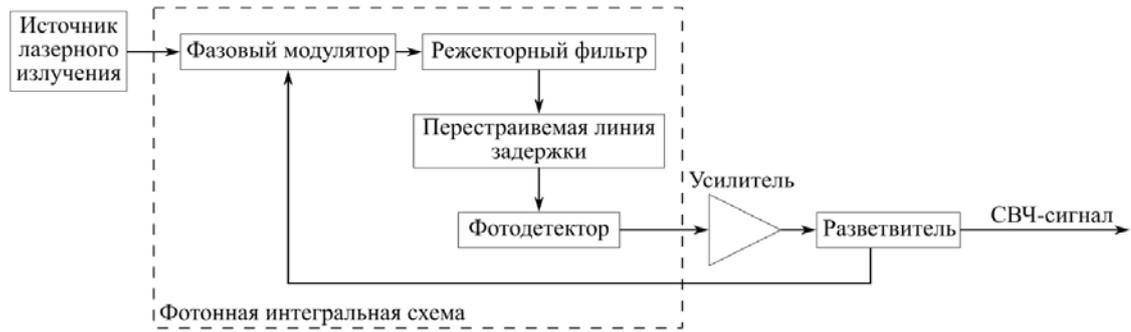
Рисунок 1. Структурная схема интегрального ОЭО, дополненного ЛЗ
