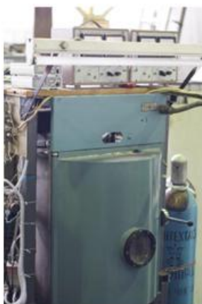
Рисунок 1 – Вакуумная установка криохимического синтеза металлополимерных тонкопленочных покрытий УВП – 2К
