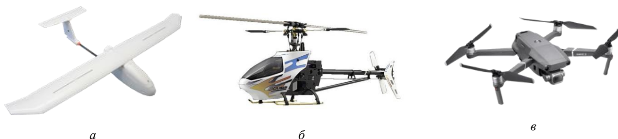
Рис. 1. Внешний вид МБЛА (а – с фиксированным крылом, б – одновинтовой, в – мультикоптер)
