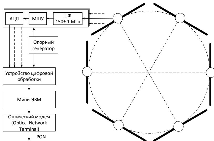
**Рис. 1. Структура дополнительной аппаратуры приемных пунктов ССП**
