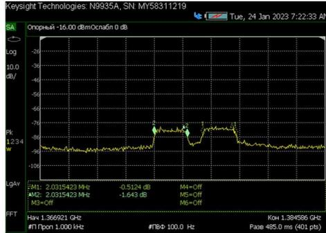
Рис. 1. Спектр сигналов в спутниковом канале
