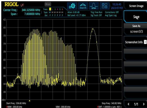
Рис. 2. Спектры сигналов в канале служебной радиосвязи
