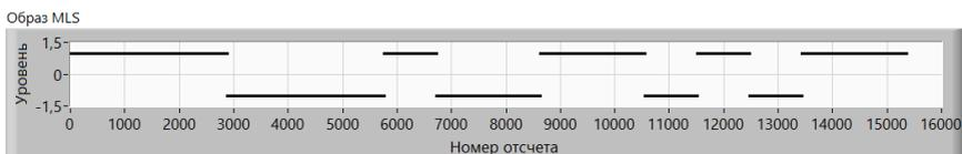
Рис. 2. Последовательность отсчетов образа MLS-последовательности
