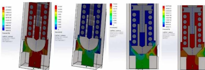
Рисунок 4. Давление и расход потока жидкости в шариковой и конической клапанной системах при потере соосности поверхности
