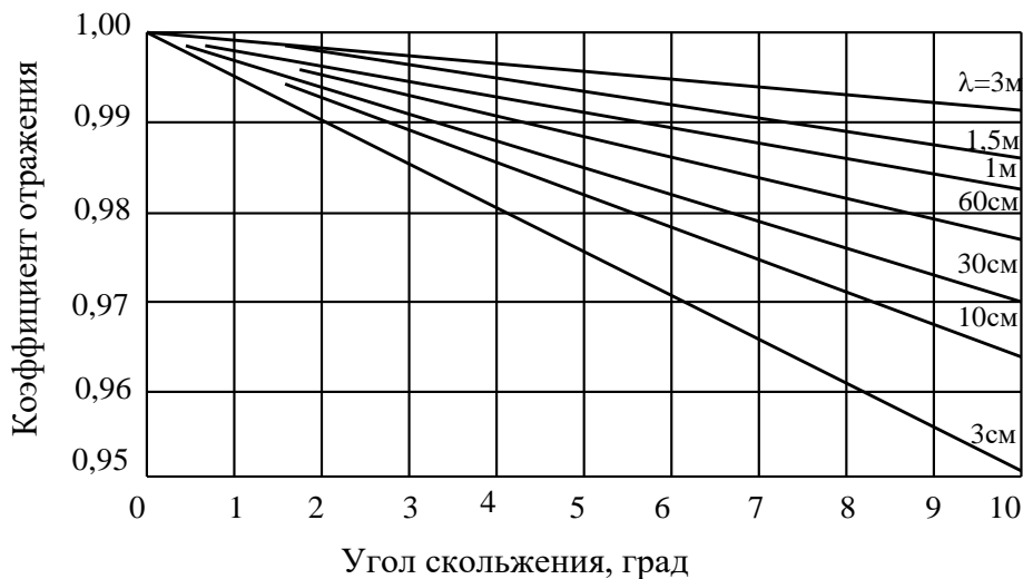
Рис. 3.8. Коэффициент отражения от гладкой морской поверхности при горизонтальной поляризации для различных длин волн
