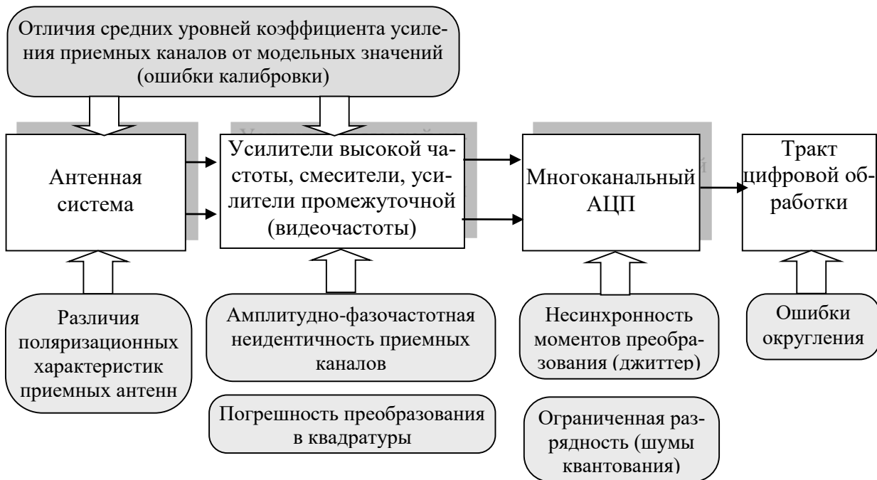
Рис. 6.12. Виды аппаратных ошибок и места их возникновения при обработке сигналов в многоканальных приемных системах
