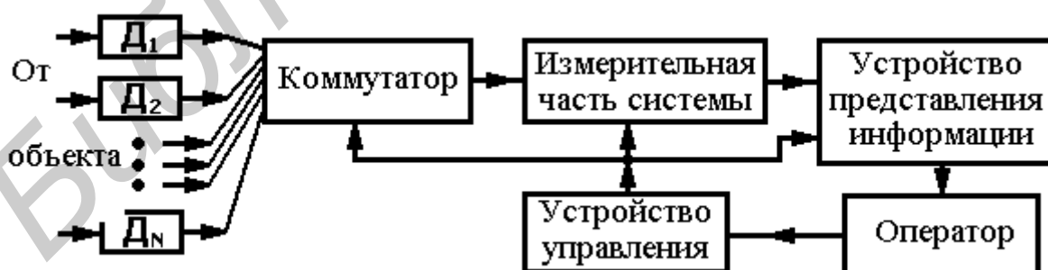
Рисунок 3 – Структурная схема ИИС с одним измерительным каналом
