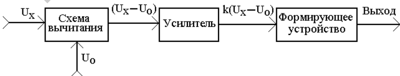
Рисунок 1.10 – Структурная схема сравнивающего устройства
