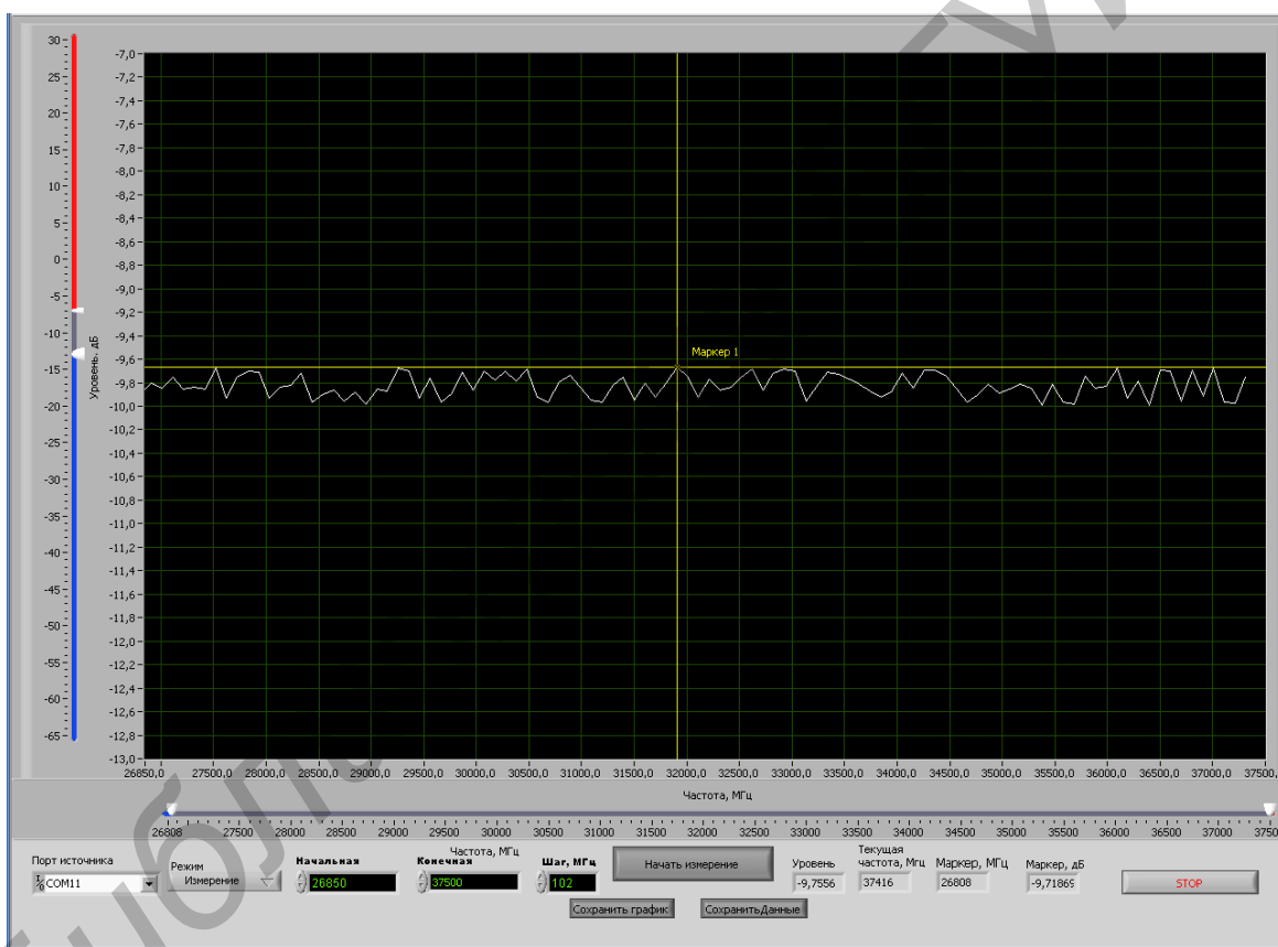
Рисунок 3.3 – Вид графической панели скалярного анализатора цепей (графический монитор компьютерно-измерительной системы)
