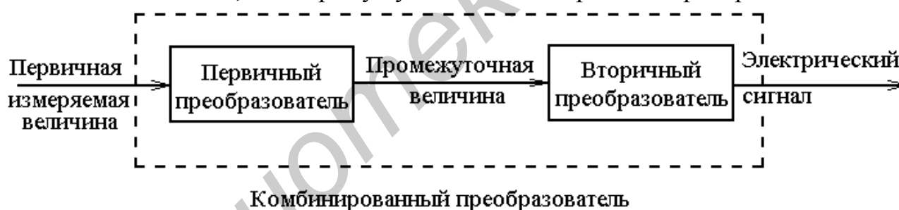
Рисунок 5.4 – Структурная схема комбинированного измерительного преобразователя
