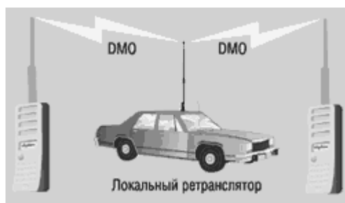
Рис.1.2. Использование ретрансляции при DMO
