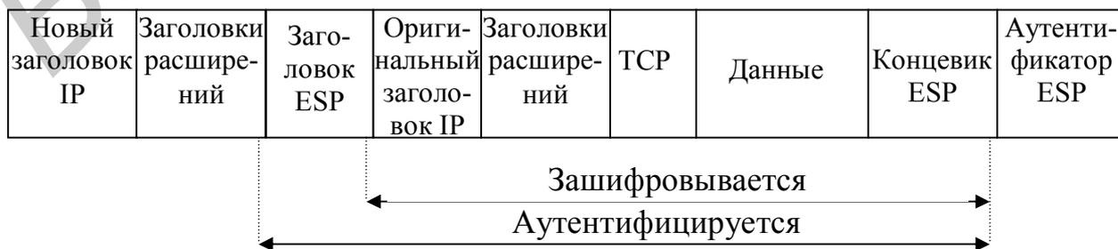
Рис. 6. Область действия шифрования и аутентификации ESP
