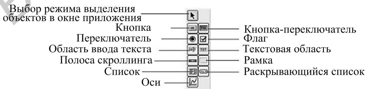
Рис. 2.4. Панель инструментов для добавления элементов интерфейса
