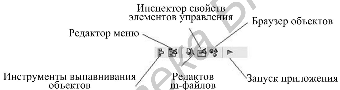
Рис. 2.5. Панель инструментов управления приложением
