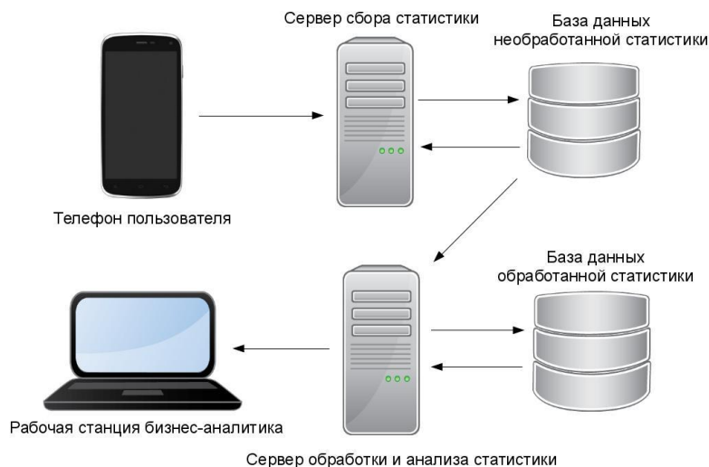
Рисунок 1. Распределенная архитектура программного средства
