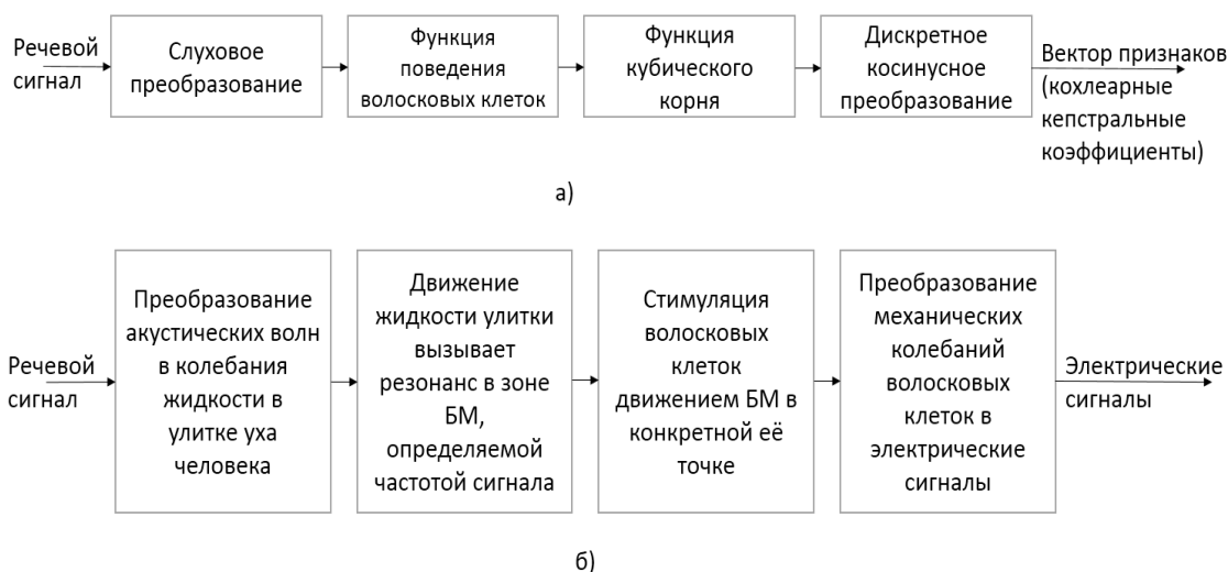
Рис.1 – Сравнение этапов обработки сигнала: а) схема рассматриваемого алгоритма экстракции; б) процесс обработки звукового сигнала в слуховой системе
