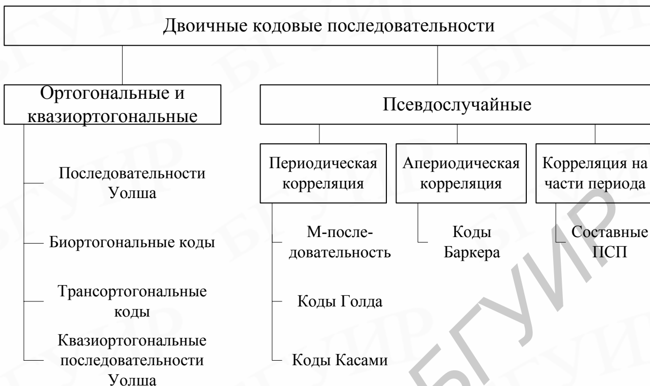
Рис. 1. Совокупность кодовых последовательностей, используемых в CDMA
