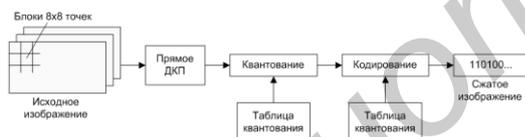
Рис. 1 – Общая схема алгоритма сжатия JPEG
