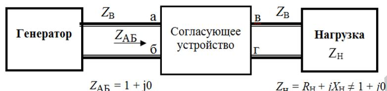
Рис. 7.10. Согласующее устройство в линии передачи с произвольной нагрузкой
