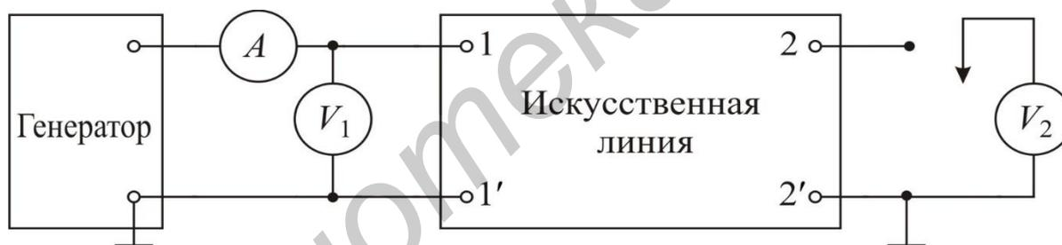
Рис. 4.6. Схема лабораторной установки
