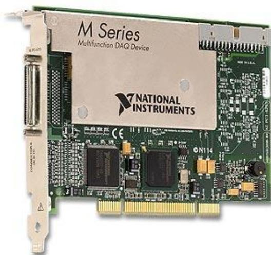
Рисунок 3.2 – Внешний вид платы сбора данных *NI PCI-6251*
